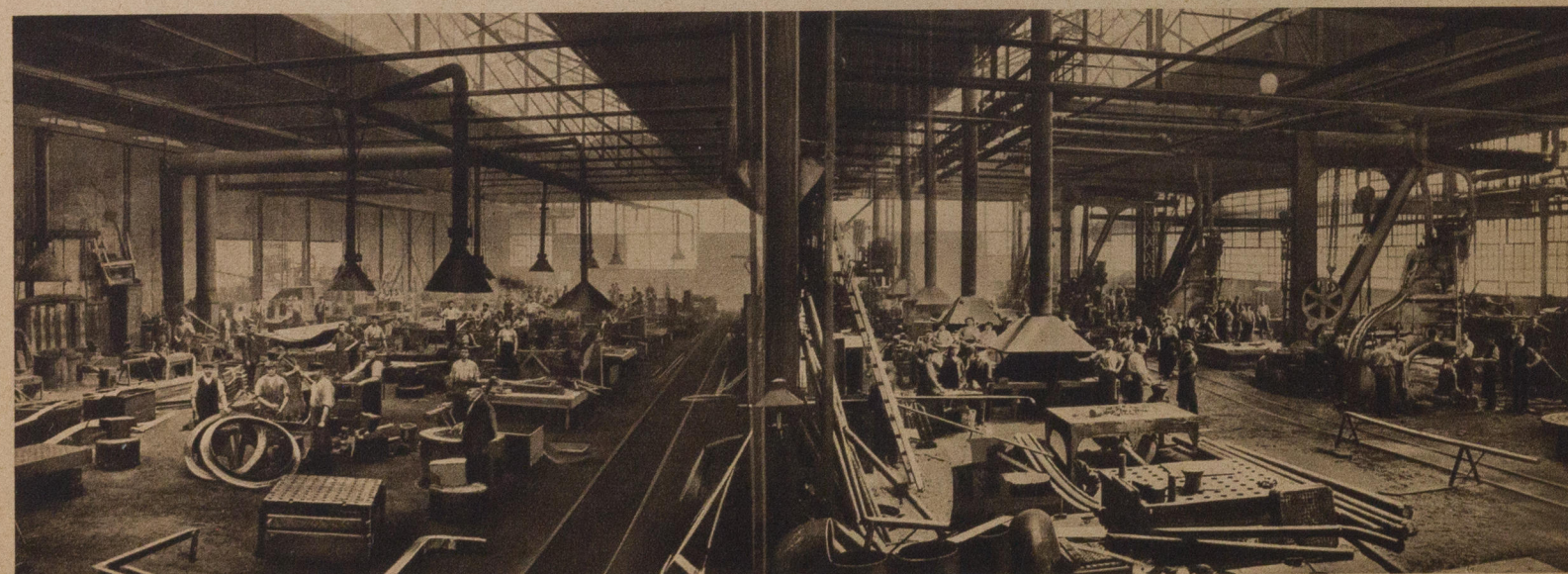
Biegen und Schmieden der Schiffswinkel
