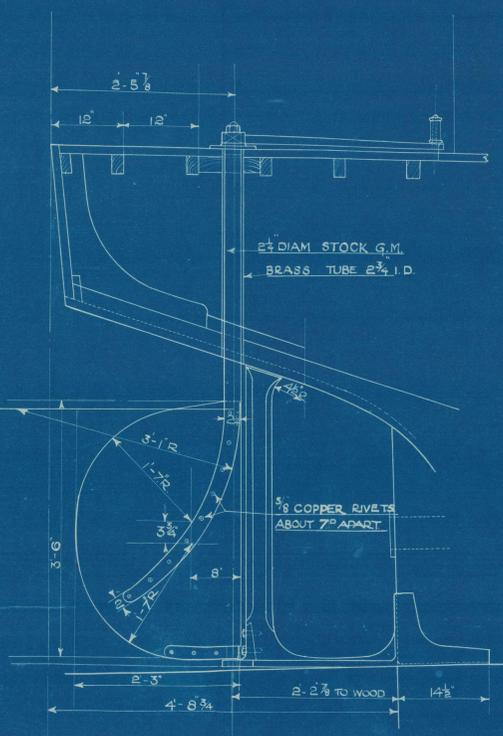
ARRANG<sup>T</sup> OF RUDDER SKEG, POSTS ETC 1 1/2" 1 FT
