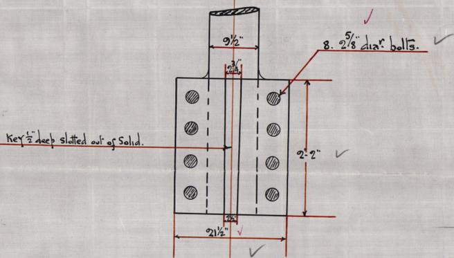
• FACE OF COUPLING ON RUDDER STOCK •
