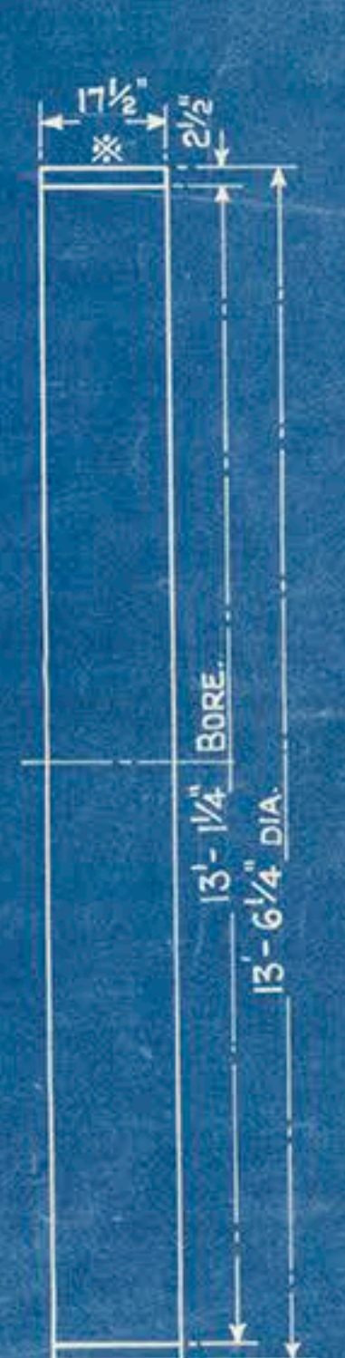
GEAR WHEEL RIM. SCALE: 1/2" TO 1 FOOT.
